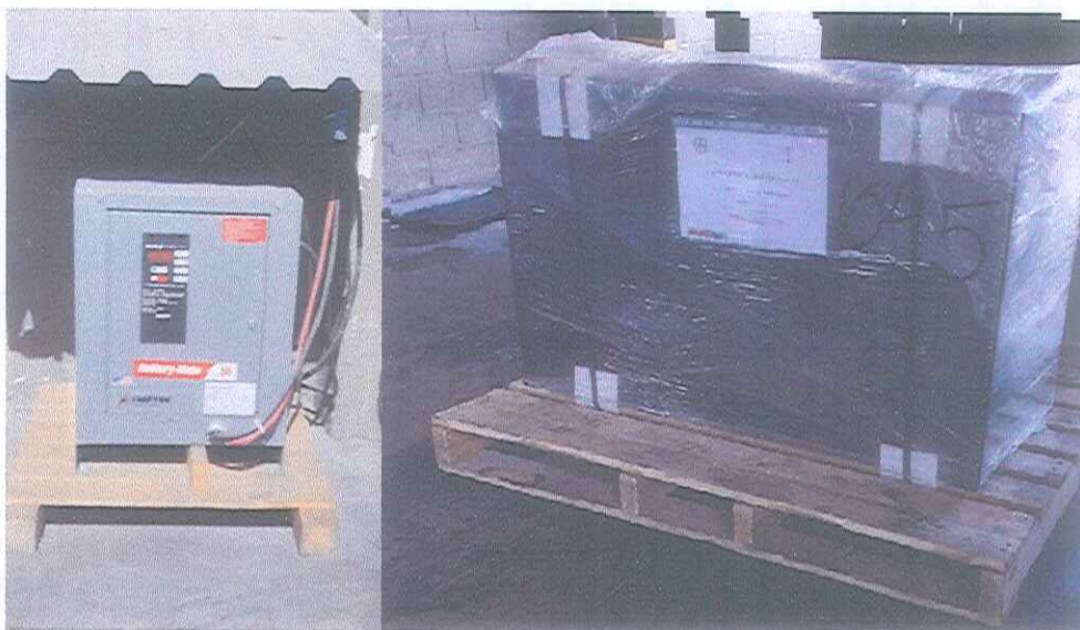
Batería de Montacargas y Cargador de baterías
